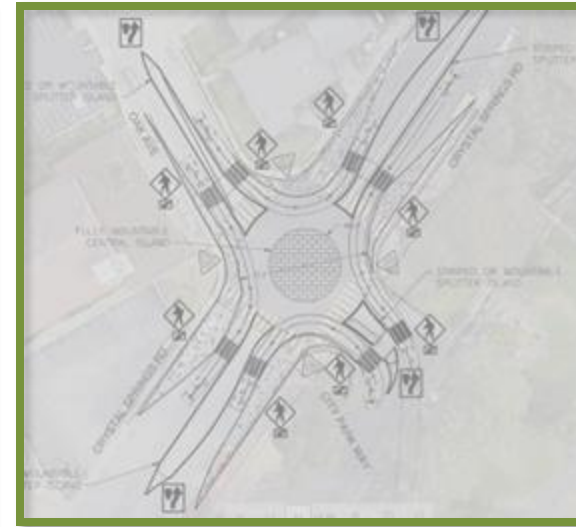
Mini Roundabout (MRA)
