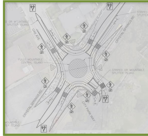
Mini Roundabout (MRA)
